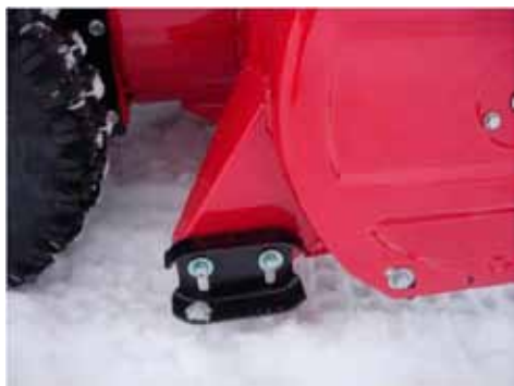
Nye glidesko. Kan monteres på yttersiden av snøhus, for økt stabilitet på hjulmodeller. Vendbare for økt levetid.
